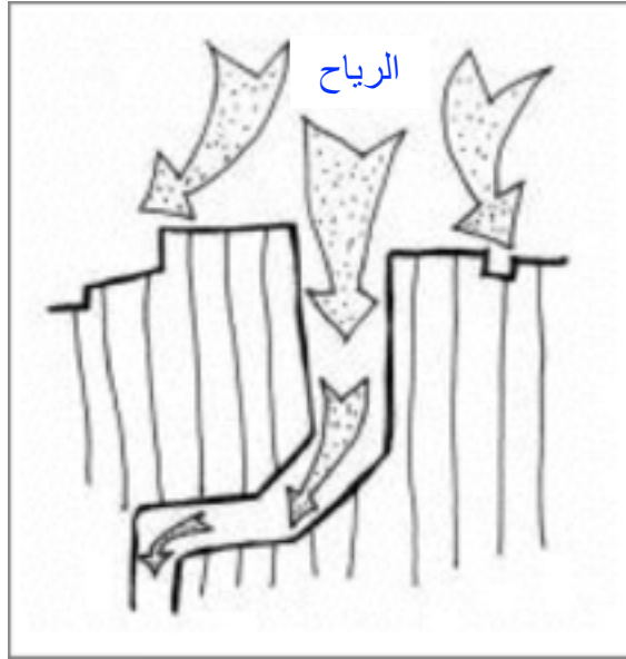
شكل ( 3 ) يوضح كيفية دخول الرياح الى الأزقة المتعرجة في مدينة غدامس القديمة
